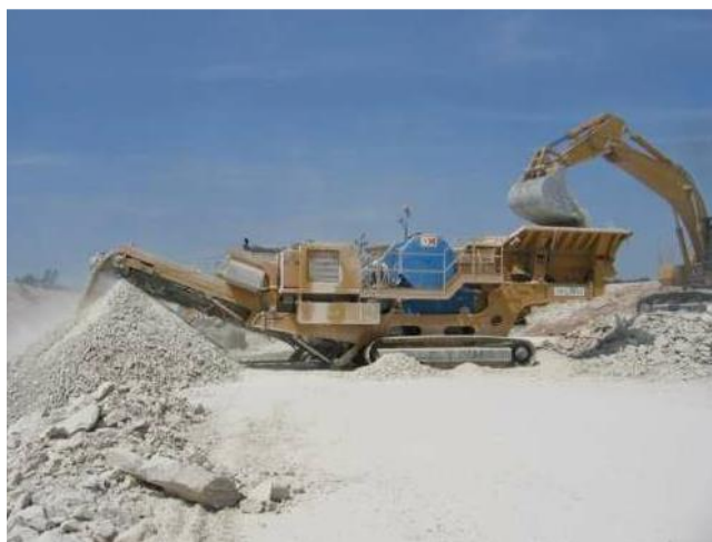
Stația mobilă de concasare
